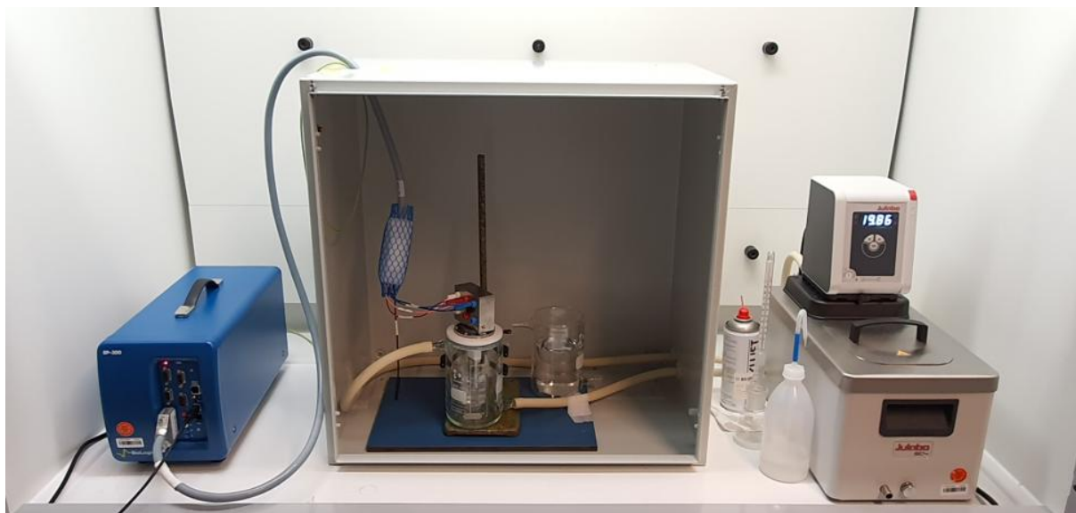
Afbeelding 1. EIS-sensor (midden) in een kooi van Faraday. Links een potentiostaat en rechts een waterbad.
